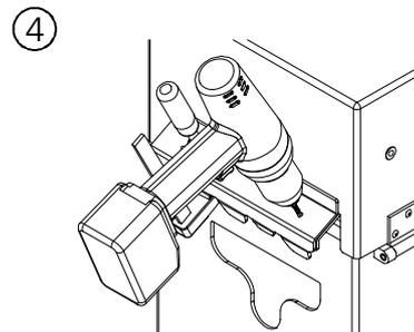
Löcher abbohren  $\varnothing 4,9$
