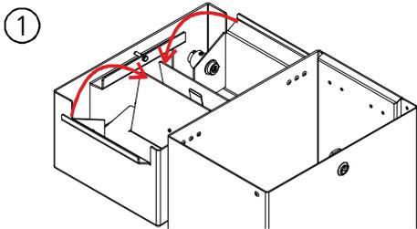
Deckel öffnen, Klappenbleche nach innen schwenken
