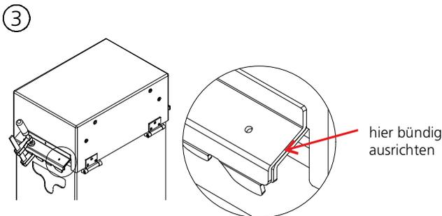
Deckel schliessen, dabei die Klappenbleche innen belassen. Abreisszunge hinten bündig ausrichten und mit Schraubzwinde fixieren
